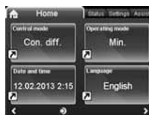
Rys. 1 Przykład głównego ekranu na pompie TPE serii 2000 z rozszerzonym panelem sterowania
