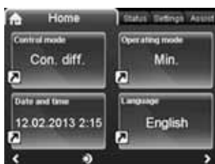
Rys. 11 Przykład głównego ekranu na pompie TPE serii 2000 z rozszerzonym panelem sterowania
