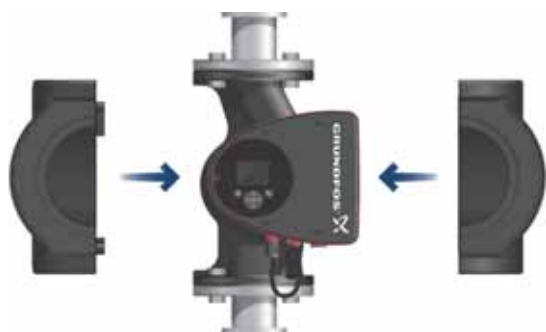
Rys. 59 Montaż okładzin na pompie MAGNA3
