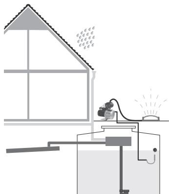
Rys. 12 Pompa JP 5 nawadniająca ogród wodą deszczową
