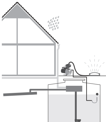
Rys. 12 Pompa JP 5 nawadniająca ogród wodą deszczową
