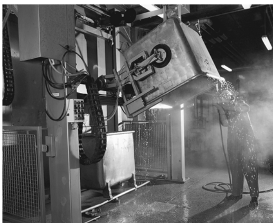
Rys. 4 Instalacje mycia i czyszczenia
