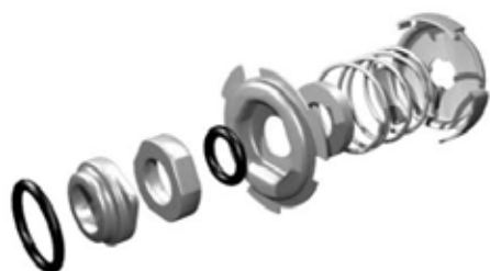
Rys. 13 Widok rozebranego uszczelnienia wału
